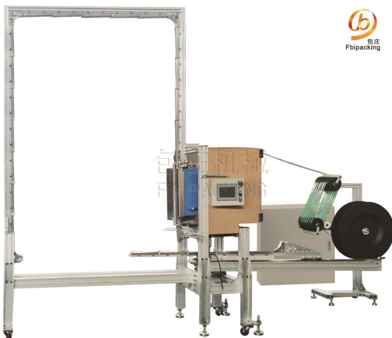
通用型全自动在线 PET 打包机
